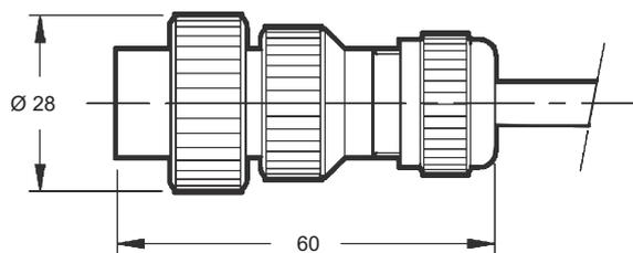
Der Außendurchmesser des Kabelmantels für den Anschlussstecker (Kabel und Stecker sind nicht im Lieferumfang enthalten) muss min. 8 mm und darf max. 10 mm betragen.
