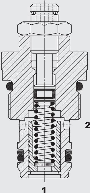
Das SR5E ist ein 2-Wege Stromregelventil, welches den Volumenstrom durch einen Regelvorgang konstant hält. Der Volumenstrom ist dabei weitgehend unabhängig vom Druck und der Viskosität.
