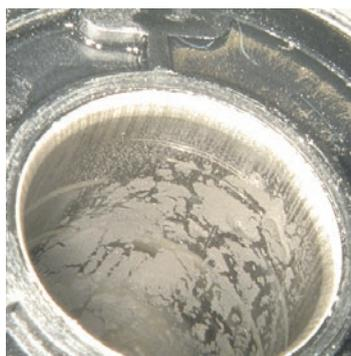
Tube polar após teste de vida útil
