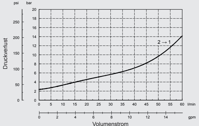
**Drosselkennlinie:**  $\Delta p$ -Q von  $1\sigma 2$  bei maximaler Aufsteuerung
