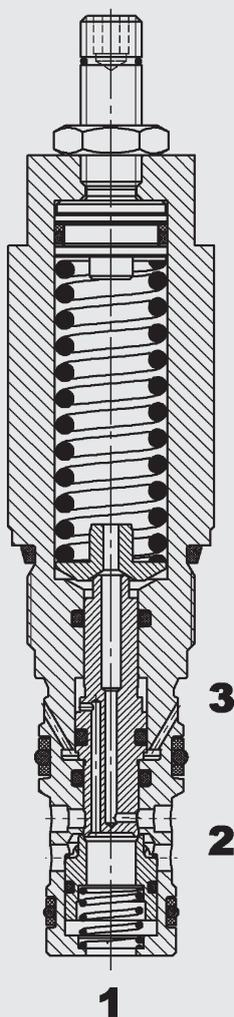
Das Senkbremssperrventil ist ein direktgesteuertes Sitzventil. Es hat die Aufgabe, eine Senkgeschwindigkeit gemäß dem zulaufenden Volumenstrom zu regeln. Ferner verhindert es ein Vorseilen des Verbrauchers bei ziehenden Lasten und ermöglicht ein ruckfreies Bewegens derselben. Es erfüllt zudem die Funktion eines Leitungsbruchventils.
