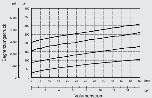
**Aufsteuerkennlinie:** Volumenstrom von 1 nach 2 über Aufsteuerdruck an 3
