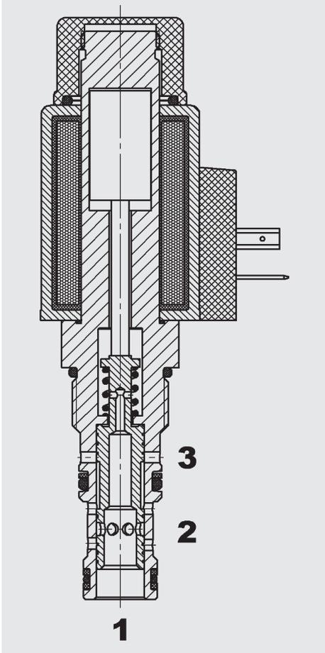
Das Proportional Drosselventil ist ein direktgesteuertes Schieberventil, welches unbestromt von Anschluss 1 nach 2 geschlossen ist. Es hat die Aufgabe Volumenströme stufenlos von Anschluss 1 nach 2 zu regeln. In Abhängigkeit vom elektrischen Signal wird ein Blendendurchmesser auf- oder zugesteuert.
