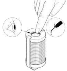
15. Geben Sie das neue Filterelement samt Bügel in die FCU. Drücken Sie das Filterelement fest nach unten in die Aufnahme.
