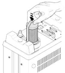
16. Setzen Sie die Verschlusschraube ein und drehen diese im Uhrzeigersinn von Hand an. Ziehen Sie die Verschlusschraube mit einem Schraubenschlüssel  $\text{⬡} = 19 \text{ mm}$  fest an.
