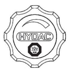
Symbol kennzeichnet die Richtung der Druckänderung bei Betätigung: Drehung entgegen Uhrzeigersinn – Druck wird verringert.
