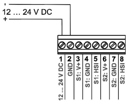
Reliez la tension d'alimentation 12 ... 24 V DC aux bornes 1 et 2 de la plaque à bornes. Veillez à ce que la polarité soit correcte.
