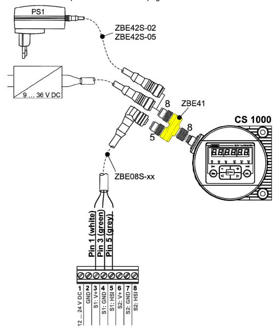
Reliez les broches 1/3/5 du capteur CS1000 aux bornes 3/4/5 sur le bornier X3.
