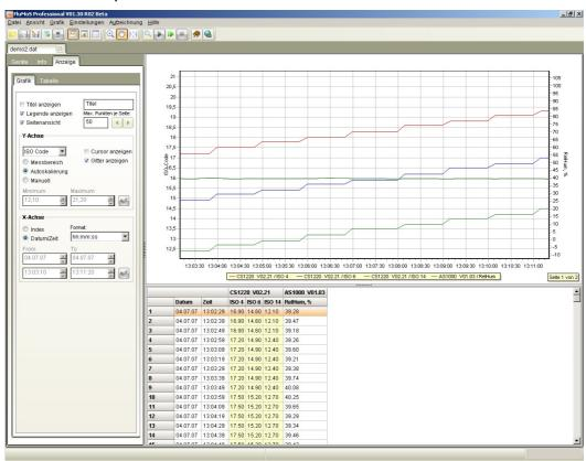
Les données des capteurs raccordés sont affichées en ligne sous la forme de tableaux et de graphiques et stockées automatiquement dans des fichiers.
