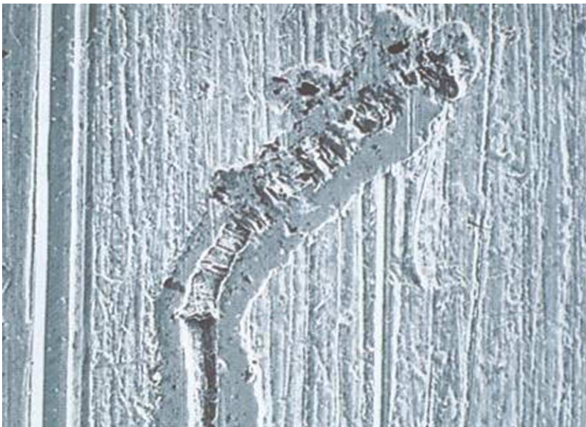
Fig. 9 Intégration d'un copeau dans la surface d'un palier lisse.
