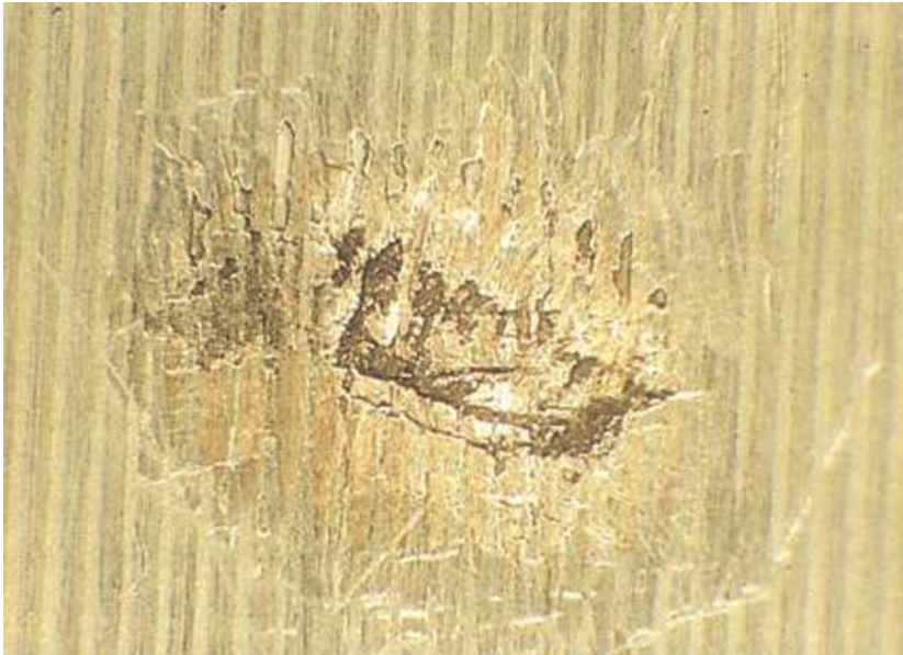
Fig. 8 Détérioration d'une bande de roulement à billes par une contamination particulaire.
