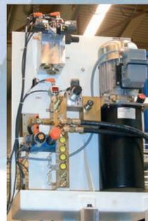
Centrale de bridage avec contrôle pneumatique de la charge
