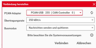
Im geöffneten Verbindungs-Dialog können Sie den gewünschten Adapter sowie die Übertragungsrate und den Busmodus auswählen.
