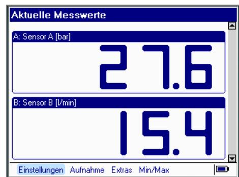
Im nebenstehenden Beispiel sind die Messwerte von **drei Sensoren** bei Auswahl der Darstellung „**2 Anzeigefelder**“ und mit Min/Max-Anzeige dargestellt. Folglich zeigt das Display nur die Messwerte jeweils zweier Sensoren an. Mit den Pfeiltasten (▲) bzw. (▼) gelangen Sie zum Messwert des dritten Sensors.
